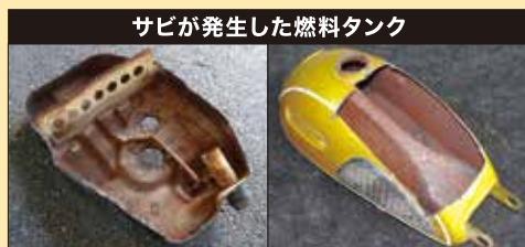
サビが発生した燃料タンク
